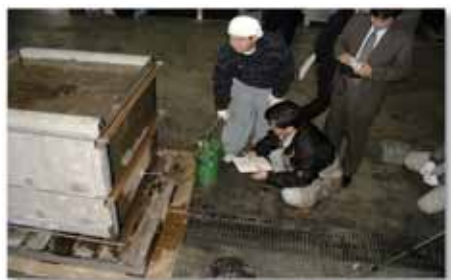
土砂圧によって、アクリル版と土砂の間を拡散する膜伸びを確認
