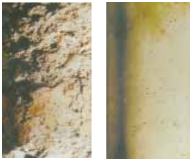
普通コンクリート アルファー・ゾル4 10kg/m 3 混入コンクリート
